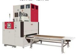
③小型 高周波木箱接着機 『TECHBOX-3WS 型 (330×330) 』 『TECHBOX-3WS型(330×515)』 オプション:円形折箱用治具、 別注機;治具レスタイプもあります。
